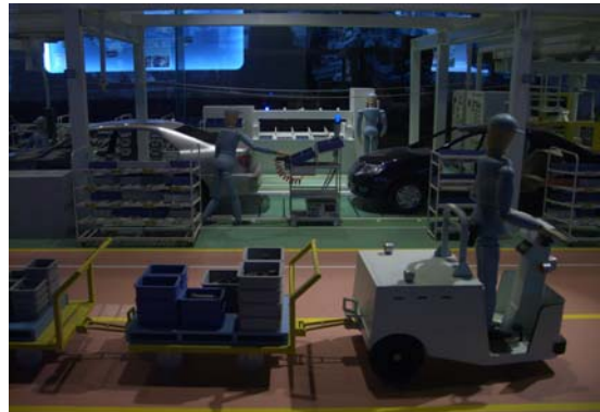
Modello di tradotta ( karugamo ) per l'approvvigionamento materiali a bordo delle linee di montaggio Toyota (Foto: JMAC_RG/ Toyota Kaikan)
